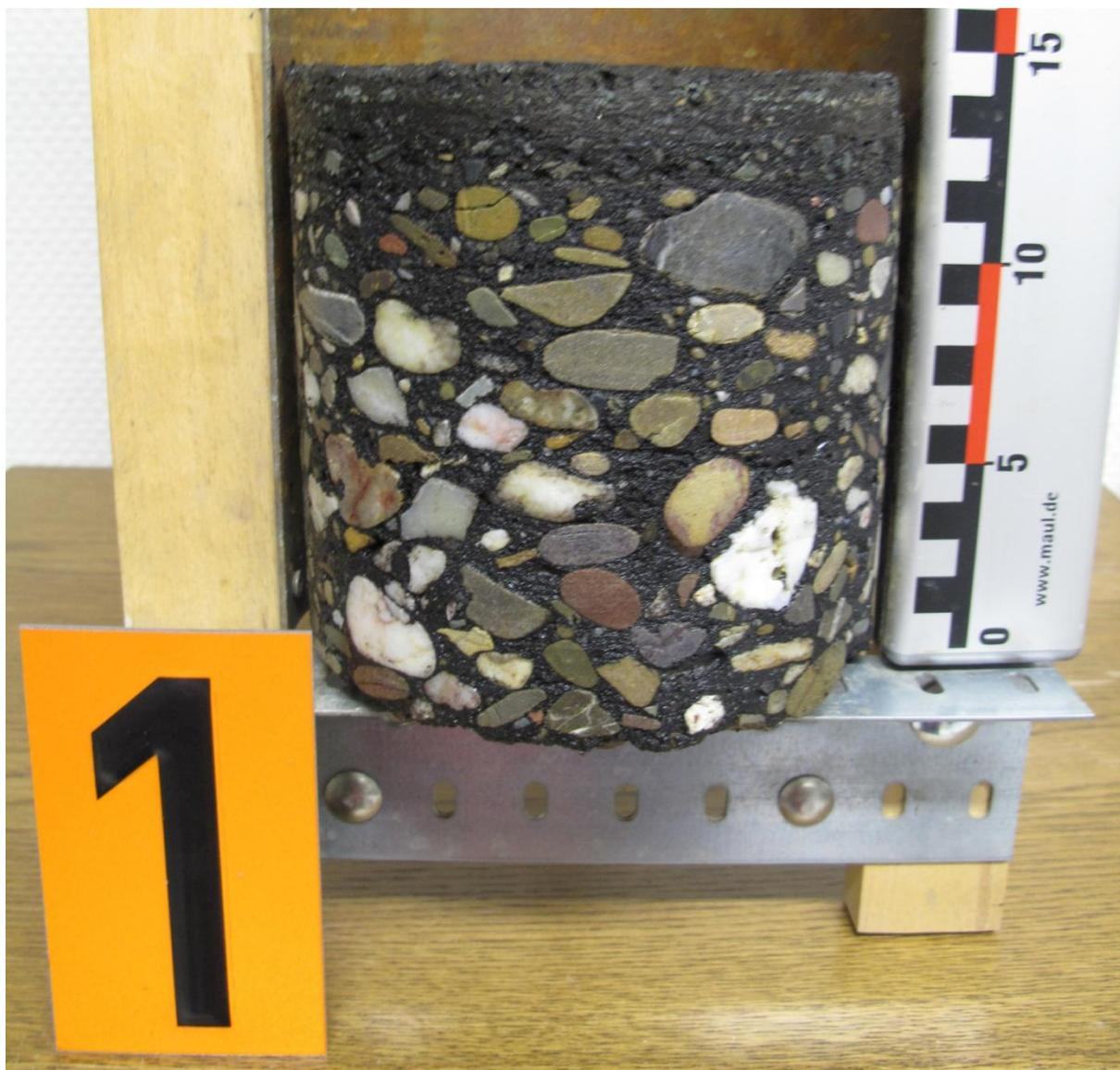
Abbildung 4 Asphaltbohrkern 01 (Station Hauptstraße 142)
