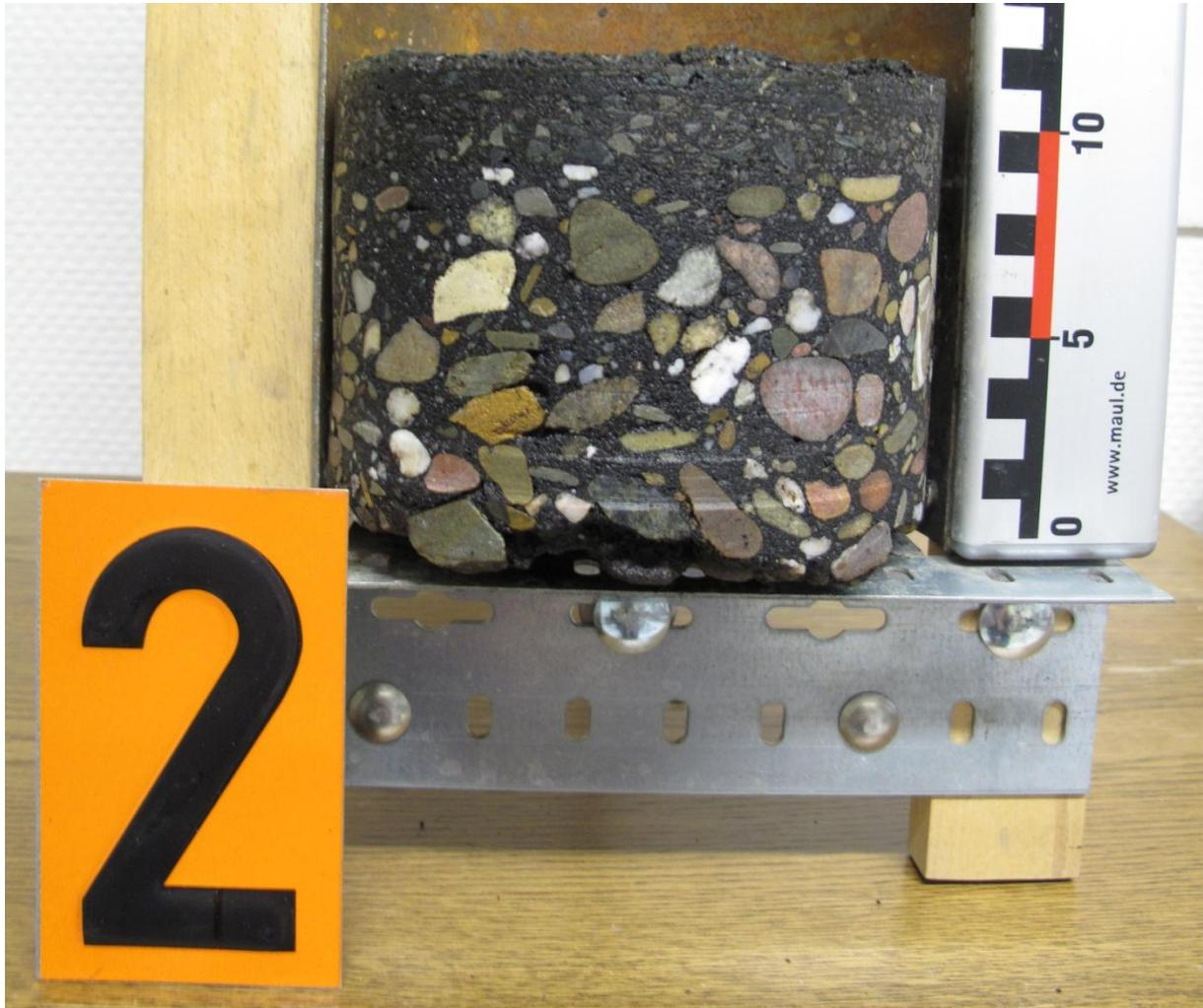
Abbildung 5 Asphaltbohrkern 02 (Station Hauptstraße 88)
